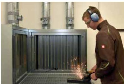
le zuschneiden. Die Schweißkojen sind mit modernster Absaugtechnik ausgestattet. Wir haben jetzt auch eine eigene Box, wo Werkstücke geschliffen werden können. Dabei wird der Schleifstaub abgesaugt und auch die Lärmentwicklung ist bis auf ein Minimum reduziert. Eine Lackierbox sorgt dafür, dass beim Lackieren ideale Voraussetzungen herrschen.
