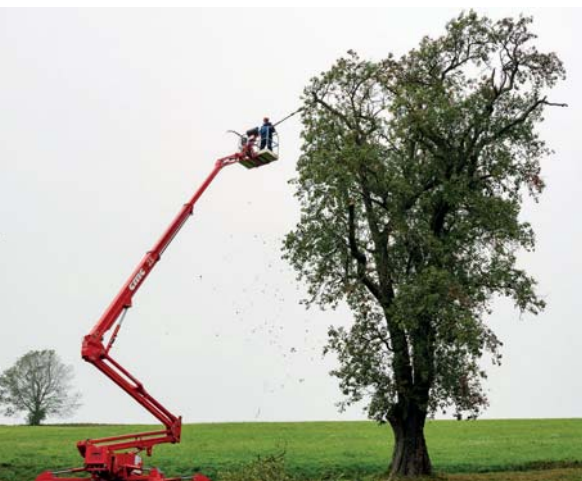
Bis zu 23 m kann der Hubsteiger ausfahren
