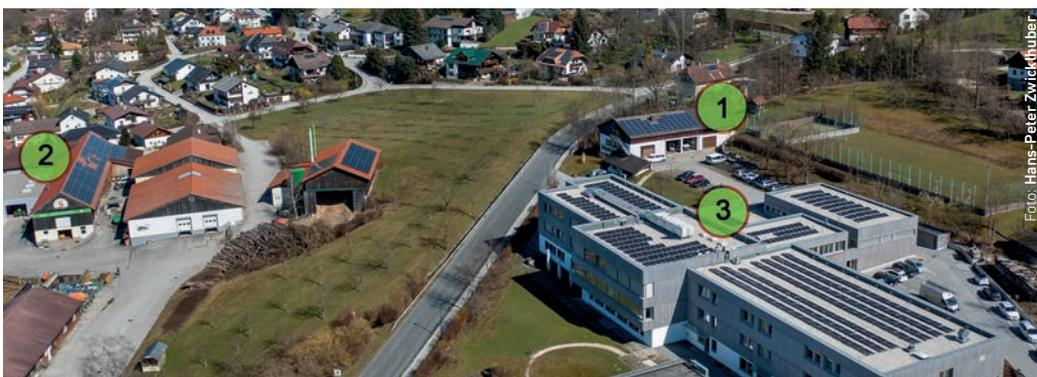
207 kWp Gesamtkapazität: 13 kWp auf der ehem. Landtechnikwerkstätte (1), 84 kWp auf dem Dach des Praxisgebäudes (2) und 110 kWp auf dem Dach der sanierten Schule (3.)
